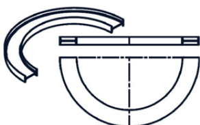
Гибка двутавра NPI на ребро
